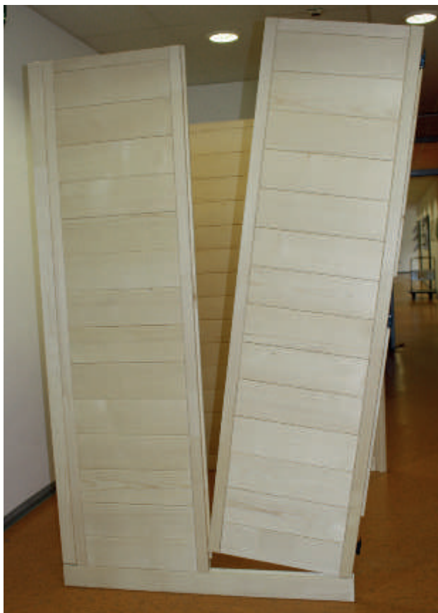
Abb. 9: Montage der beiden vorderen Ecksteher mit Nut für Glas
