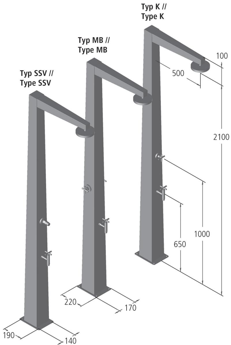
Bohrungsabstände // Hole separation
