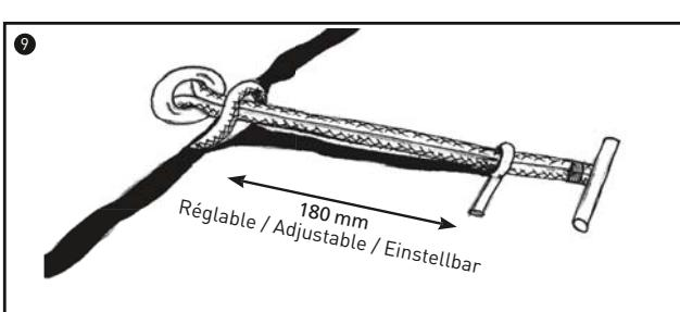
9 Modèles EVOLUTION et STARLIGHT non équipés de l'option WINDSAFE (système anti-soulèvement sur les longueurs) : Pour les fixations (tendeurs cabiclics avec pitons) sur longueurs, percer avec une légère inclinaison extérieure (afin qu'un piton ne puisse glisser et sortir du trou) en diamètre 7 mm avec une profondeur de 80 mm. Placer les tendeurs cabiclics dans les œillets en réalisant une boucle suivant schéma.
