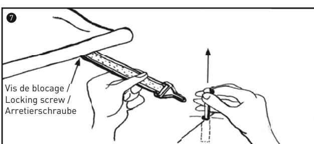
7 Soulever à la main les pitons escamotables et y fixer ensuite les sangles de fixation. Bloquer les sangles en translation, en serrant les vis de blocage positionnées dans la gorge du profil à l'aide de la clé Allen fournie.
