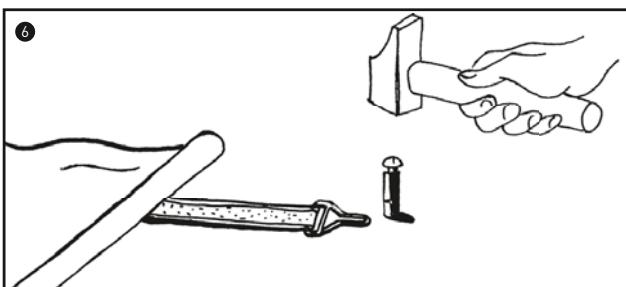
6 Mettre en place les pitons inox avec douille, à l'aide d'un marteau.
