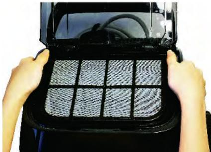
7.5 Nach der Reinigung, den Korb wieder in den Roboter einsetzen. Wenn der Korb nicht richtig ausgerichtet ist, ist es nicht möglich, die Abdeckung des Reinigers zu schließen.
