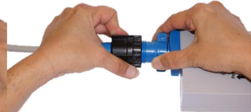
5.6 Wiederholen Sie den Vorgang auf der blauen, mit „POOL ROBOT“ beschrifteten Seite mit dem vom Roboter kommenden Kabel.
