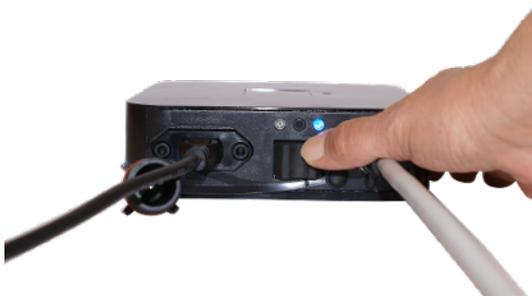
5.9 Um den 1 Stunde-Reinigungszyklus auszuwählen, drücken Sie auf der linken Seite des Schalters unter dem blauen Licht des Transformators.
