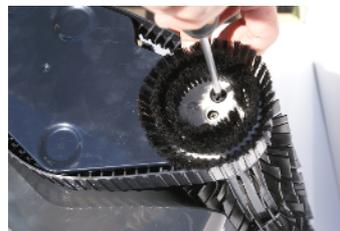
Befestigen Sie die Seitenbürsten mit den Schrauben Benutzen Sie einen Schraubendreher,
