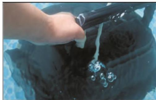
5.8 Setzen Sie den Reiniger in den Pool und warten Sie, bis dieser vollständig eingetaucht ist. Bei Bedarf helfen Sie beim versenken manuell nach, bis die Lufts aus dem Gerät entwichen ist.
