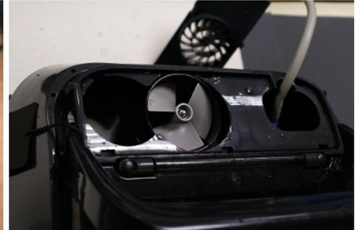
8.2 Reinigen Sie den Impeller.
