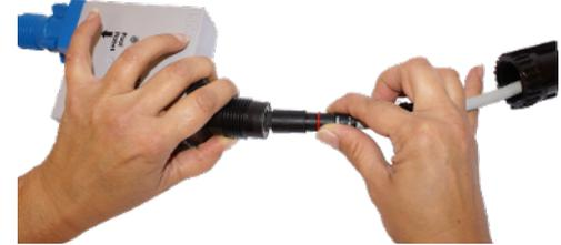
5.3 Stecken Sie das Ende des vom Transformator kommenden Schwimmkabels in die schwarze "POWER"-Buchse. Achten Sie auf die Ausrichtung des Steckers.
