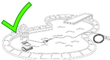
5.11 Für optimale Reinigungsergebnisse, geben Sie ausreichend Schwimmkabel ins Becken, aber nie mehr als nötig, um jede Stelle im Becken zu erreichen. Begrenzen Sie die Länge des Kabels in den Pool auf ein Minimum zu und platzieren Sie das überschüssige Kabel außerhalb des Beckens ab.
