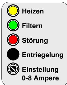
Die Drehstrom-Filterpumpe wird durch einen steckbaren, elektronischen Motorschutz vor Beschädigung durch Überlastung geschützt. Dazu muß der Motorschutz auf den Nennstrom der Filterpumpe (siehe Typenschild der Pumpe) eingestellt sein. Falls dieser nicht bekannt ist, kann der Motorschutz nach folgendem Verfahren eingestellt werden:
