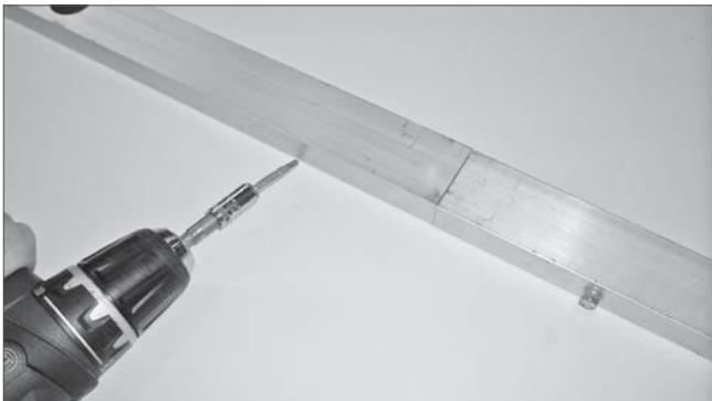
Nun die Erweiterungsmontage bündig über das Verbindungs-Rechteckrohr schieben und ebenfalls mit einer Bohrschraube an der flachen Seite circa 100 mm vom Profilkopf verschrauben.
