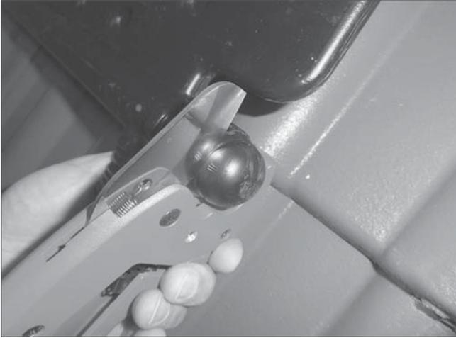
Die benötigten Anschlussstutzen mit einer Rohr-/Schlauchscherer aufschneiden.
