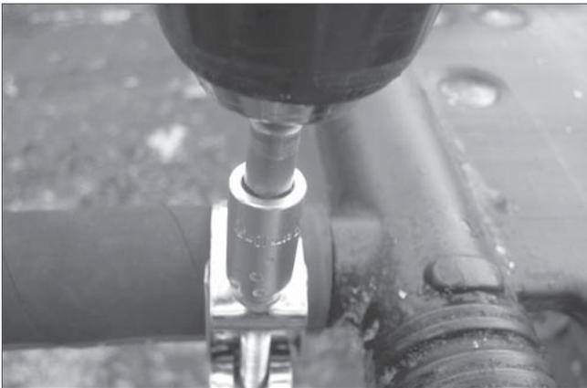
Zum Absperrn nicht benötigter Anschlüsse ( $\varnothing 25$ ) mittels Endstopfenset, ist zunächst der Gewebeschlauch mit Schlauchschellen zu befestigen.
