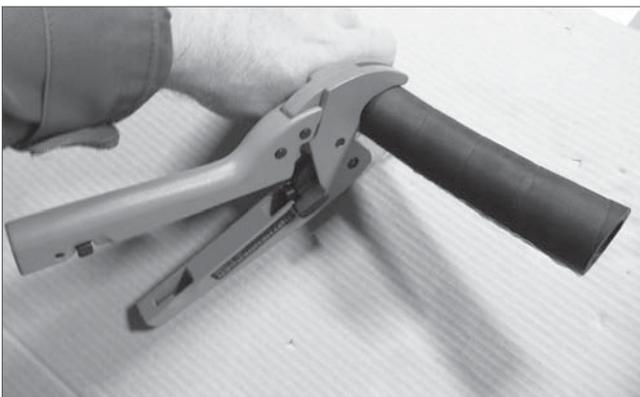
Die im Verbindungsset und Endstopfenset enthaltenen Gewebeschläuche mit einer Rohr-/Schlauchscherer auf die erforderliche Länge kürzen.
