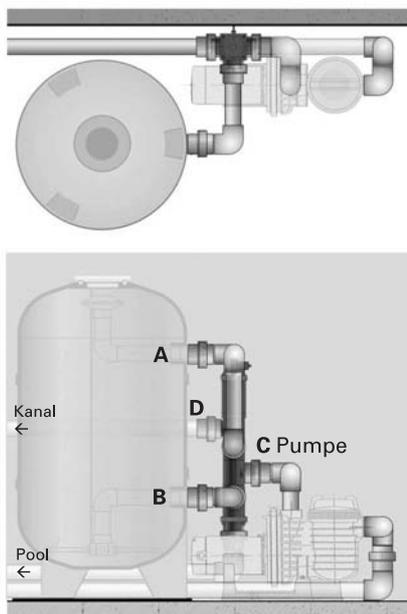
**besgo** VENTILE, ab DN65 / DN80 und DN100 sollten mit Rohrschellen an der Wand montiert werden (bauseits).
