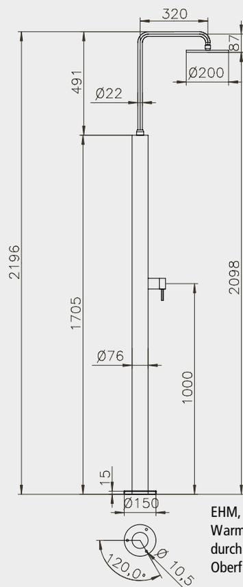
EHM, Kalt- und Warmwasseranschluss 1/2" durch den Bodenflansch, Oberfläche geschliffen
