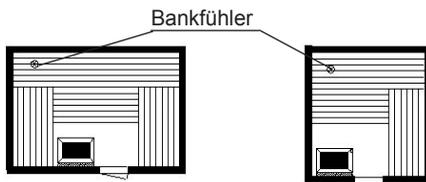
Der Bankfühler wird über eine 2-adrige Silikonleitung am Steuergerät an den Klemmen auf der rechten Seite der unteren Platine angeschlossen. Gekennzeichnet durch die Beschriftung "Temp.-Sensor Nr.2" .
