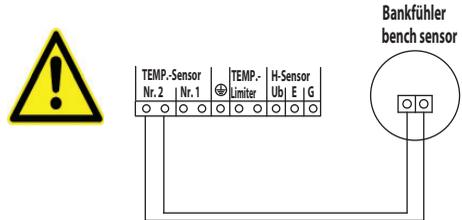
Achtung: Achten Sie auf den korrekten Anschluß - Falschanschluß kann zum Defekt des Fühlers führen.
