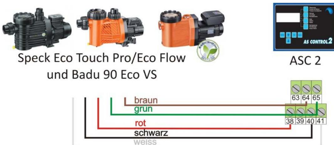
Abbildung 14: Anschließen von Speck Eco Touch Pro und Badu 90 Eco VS
