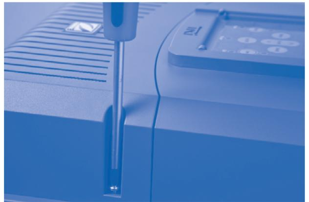
Das untere Modul vorsichtig von der Einheit des TRi-Salzelektrolysegeräts abnehmen.
