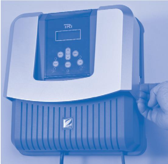
Die zwei Schrauben, die das untere Modul an der Haupteinheit halten (siehe unten) entfernen:
