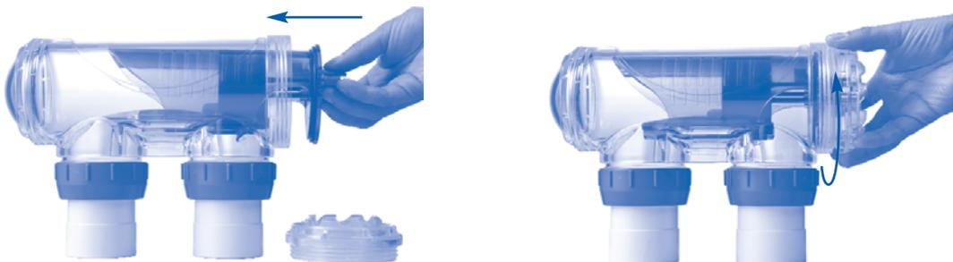
7. Den Spannring wieder festziehen, das Zellenkabel wieder anschließen und die Abdeckkappe einsetzen. Die Filterung und das TRi-Salzelektrolysegerät wieder einschalten.
