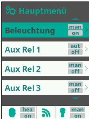
Der Salt Relax PRO erlaubt die Steuerung von bis zu 4 zusätzlichen Funktionen (z.B. für Wasserattraktionen, Gegenstromanlagen, Gartenbeleuchtung usw.). Diese Funktionen werden an die bis zu 4 zusätzlichen Relais angeschlossen.
