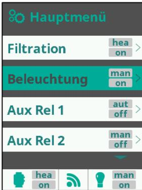
Der Salt Relax PRO erlaubt ein direktes oder zeitgesteuertes Ein- und Ausschalten einer Beleuchtung (z.B. Unterwasserbeleuchtung oder Beleuchtung Schwimmhalle).
