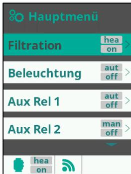
Das Menü Filtration erlaubt die Einstellung der Ansteuerung der Filterpumpe. Darüber hinaus kann hier, je nach Menüpunkt, die Steuerung der Heizung mit einbezogen werden.
