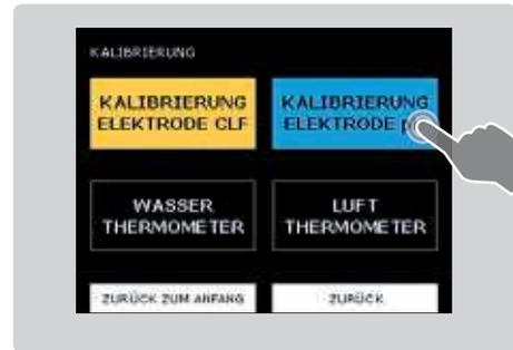
4. Vergleichen Sie die Messung auf Ihrem ASIN Aqua mit der Messung, die Sie manuell durchgeführt haben. Falls Unterschiede bestehen, passen Sie die Anzeigen auf Ihrem ASIN Aqua an, indem Sie sowohl auf die + als auch auf die - Taste drücken, bis sie übereinstimmen. Klicken Sie dann auf OK, um die Einstellung zu speichern.
