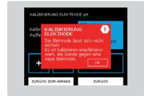
Sollte der Unterschied zwischen dem Wert des manuell durchgeführten Tests und dem Anzeigewert auf dem pH-Ventil grösser als 1 sein, wird die folgende Meldung angezeigt.
