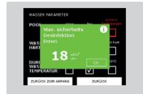
**WARNUNG:** diese Parameter beeinflussen die maximale Desinfektionsdosierung pro Stunde.
