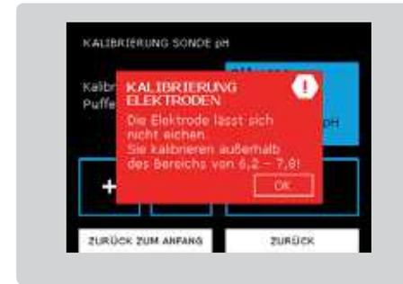
Sollte der Wert des manuell durchgeführten Tests außerhalb des pH-Bereichs 6,2 – 7,8 liegen, wird die folgende Meldung angezeigt.
