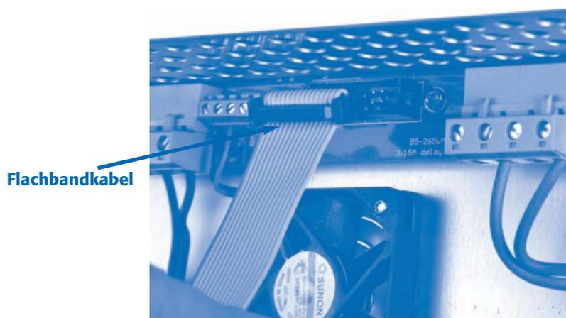
5. Führen Sie das Kabel des externen Controllers durch das Loch (eine –nicht mitgelieferte– Kabeldurchführung kann gegebenenfalls entsprechend dem Durchmesser des benutzen Kabels notwendig sein). Platzieren Sie, wie angegeben, einen Kunststoffkabelbinder am Kabel des externen Controllers, um jedes Abreißen zu verhindern.
