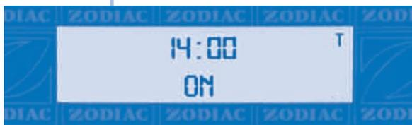
Anmerkung: Wenn ein Zeitfenster für die Programmierung eingegeben worden ist, wird eine kleines Symbol 'T' oben rechts auf dem LCD Bildschirm angezeigt.
