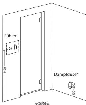
\*) Die Dampfduse(n) soll(en) diagonal zum Fühler montiert werden, so dass eine möglichst große Entfernung erreicht wird. Bei 12 - 18 kW Dampfgeneratoren wird die Installation von zwei Dampfduesen empfohlen, um eine bessere Dampfverteilung zu erreichen.
