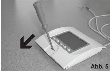
Entriegeln Sie das Gehäuse durch leichtes Drehen oder Kippen des Schraubendrehers in Pfeilrichtung (Abb.5) und schwenken Sie das Gehäuseoberteil nach oben.
