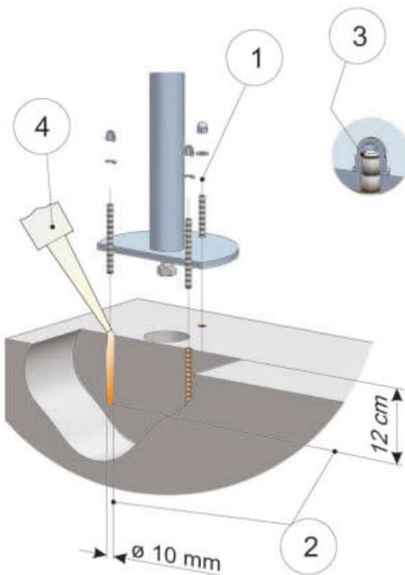
1. Platzieren Sie die Duschsäule und markieren Sie drei Löcher zur Befestigung.
