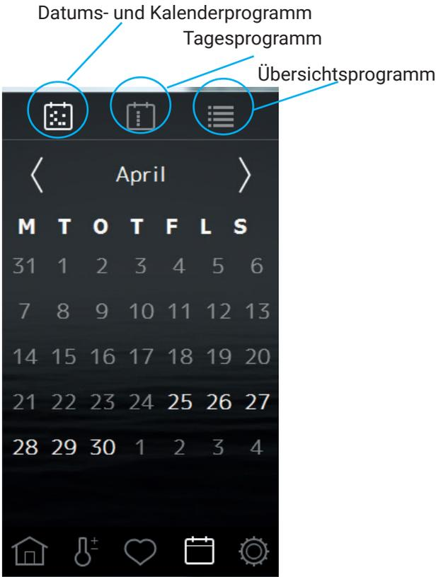
Um die Kalenderfunktionen für die Bastu und Combi Heizungen wie auch für die Tylarium-Installation nutzen zu können, wird ein Türschalter benötigt in der EU Regionen, der mit der Tür verbunden ist (Tylö Artikelnummer 90908035). Dies ist auch erforderlich, um WLAN für die Saunabeheizung und die Combi-Beheizung nutzen zu können.
