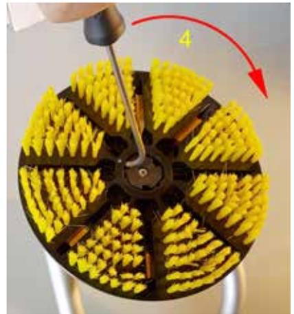
Hebeln Sie die Bürste mit dem Bürstenausheber nach oben (4) und ziehen dann die Bürste von dem Antriebszapfen ab.
