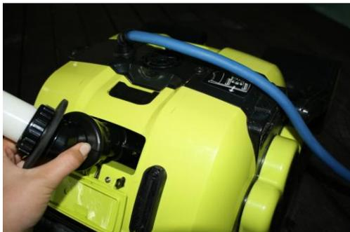
Schließen Sie nun das Schwenkgelenk an. Hierbei muss der Markierungszahn nach oben zeigen.
