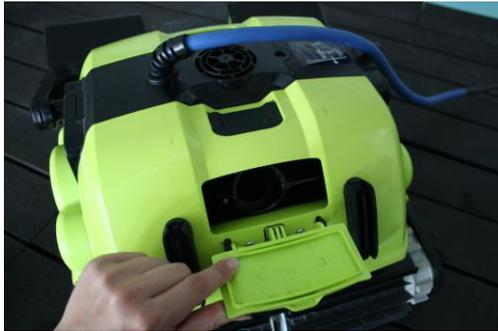
Klappen Sie die Klappe für den Anschluss des Saugschlauchs nach unten.
