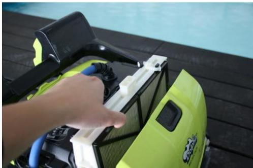
Entfernen Sie die beiden Filterkartuschen des DOLPHIN-SUPREME-BIOs. Hierfür öffnen Sie die beiden oberen Klappen.
