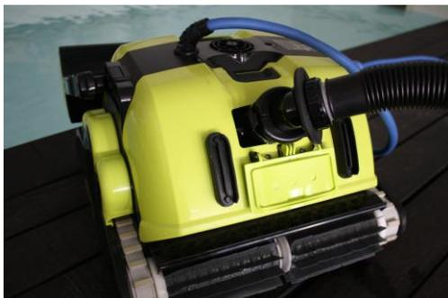
An das Schwenkgelenk können Sie nun den Saugschlauch anschließen. Nutzen Sie die Verbindungsstücke hierbei, um den Saugschlauch und das blaue Verbindungskabel zu koppeln. Die beiden Schläuche sollten auf der gesamten Länge des Saugschlauches verbunden werden.
