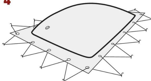
Zum Schluss die noch benötigte Luft nachpumpen, bis die benötigte Form und der gewünschte Härtegrad erreicht sind.
