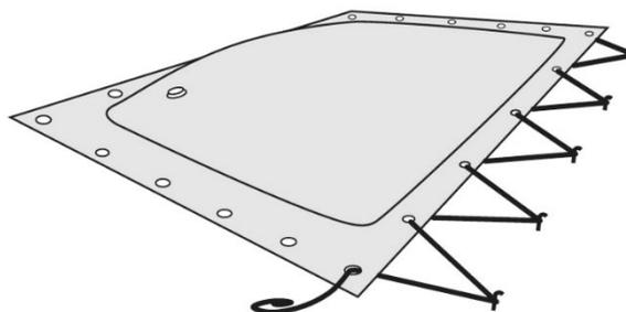
Nun die Poolplane so verspannen und rundum befestigen, dass nur die seitliche Abschweißung über dem Poolrand übersteht.
