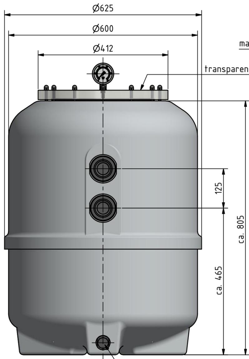
Manometer mit manueller Entlüftung
