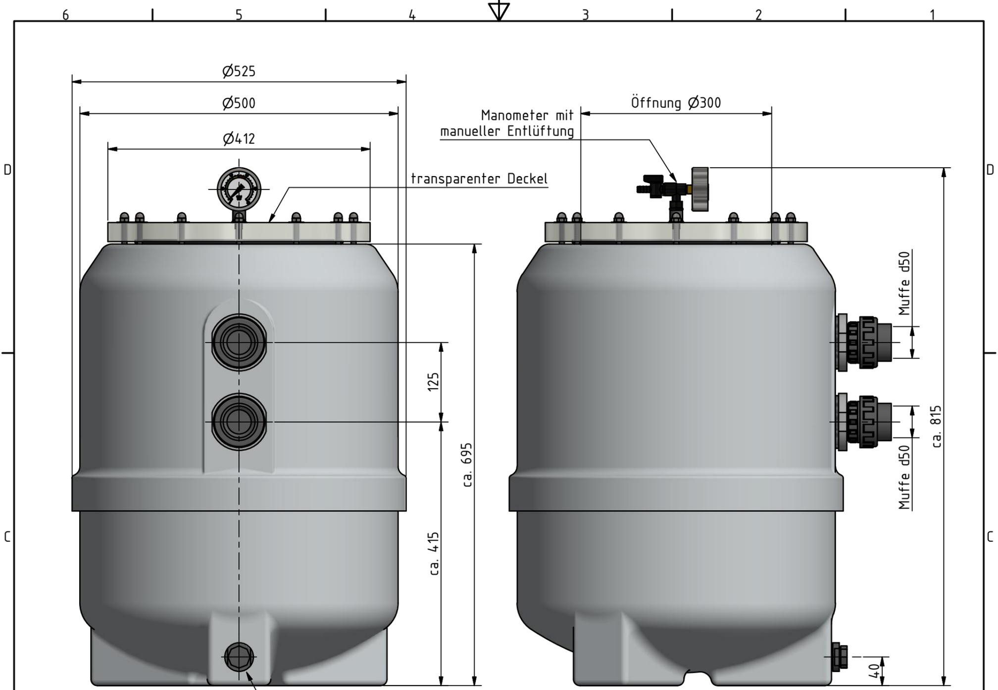
PVC-Entleerung mit Muffe 3/4"-Anschluss im Fuss
